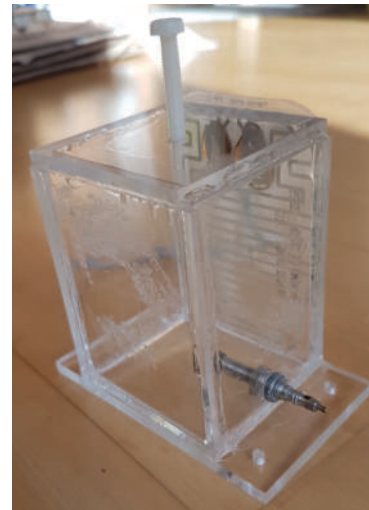
Abb. 17: Versuchskörper mit Heizfolie, Ventil & Plastikschrabe [f]
