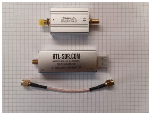
Abbildung 4: Oben: LNA Mitte: RTL2832U Unten: RG316 Kabel
