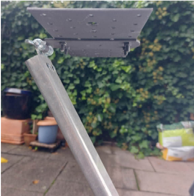
Abbildung 22: Scharnier als Verbindung zwischen Arm und Lochplatte [70]
