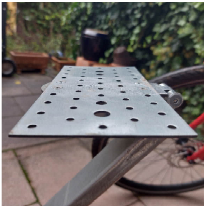
Abbildung 21: Lochplatte mit Scharnier und abgefeilten Schrauben [69]
