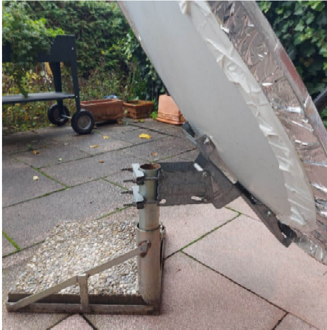
Abbildung 24: Schrauben auf der Rückseite des Kochers zum präzisen Ausrichten [72]
