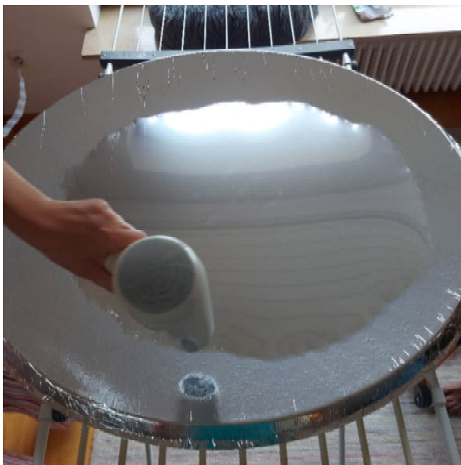
Abbildung 20: Erzeugen der parabolischen Spiegelfläche [68]
