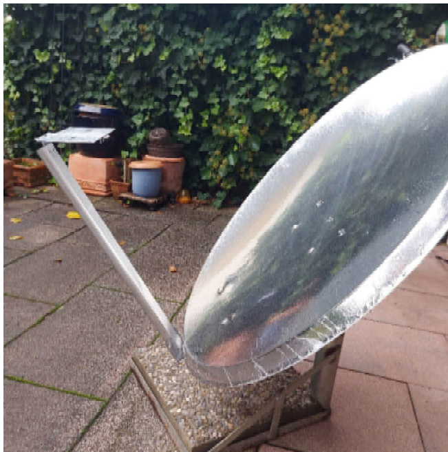
Abbildung 25: Fertiger Solarkocher in finaler Form mit Halterung [73]
